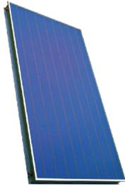
Absorbedor continuo de cobre con tratamiento selectivo BLUETEC soldado por ultrasonidos a un colector de cobre tipo arpa. Soldaduras en el absorbedor realizadas por inducción y estanqueidad testeada a 15 bar cada unidad. Carcasa de aluminio anodizado de alta calidad. Cubierta transparente de vidrio solar templado de alta resistencia y baja emisividad. Cubierta posterior de lámina térmica de polipropileno. Todo el proceso dispone de certificaciones ISO 9001 e ISO 14001.
